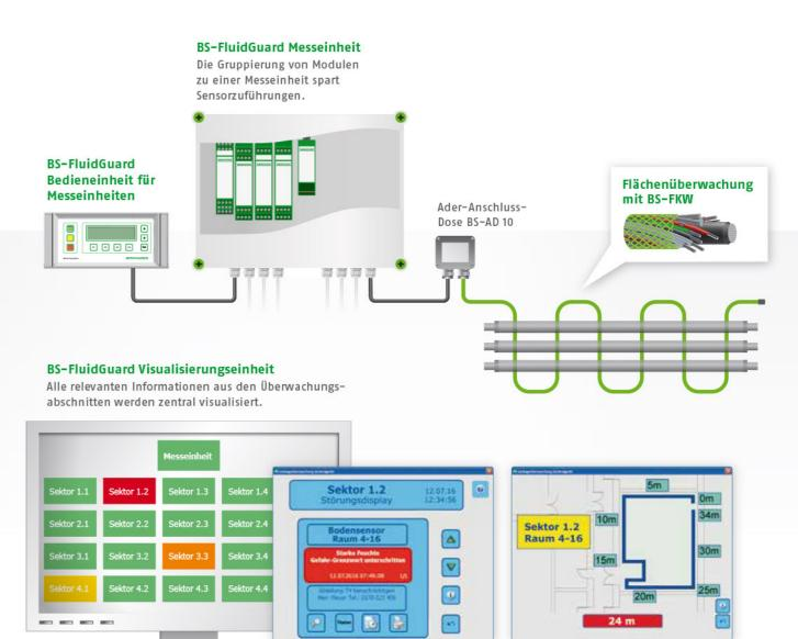
Über die komfortable BRANDES Software kann der Status des Systems im Leitstand schnell und überschaubar überwacht werden. GLT Alarme Meldungen via WEB, OPC, ODBC
